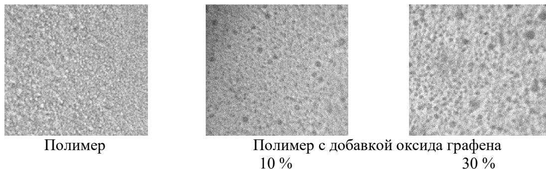
Рис. 4. Фото полимера и с добавлением минерального наполнителя в разном процентном соотношении
