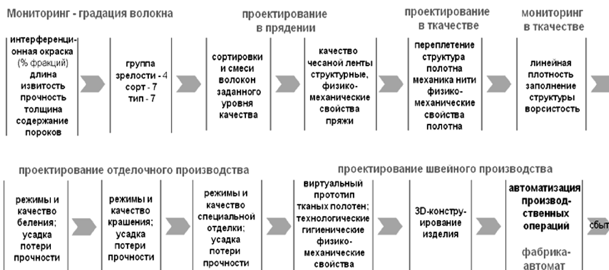
Рис. 1. Основные задачи цифровых технологий в производстве хлопчатобумажной продукции
