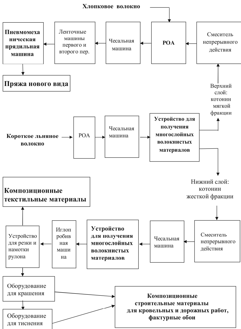
Рис. 1. Схема технологической линии подготовки и получения композиционных материалов различного назначения
