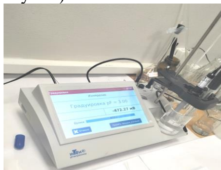
Рисунок – Установка для потенциометрического анализа на базе на pH-метра/иономера ИТАН (Томьаналит, Россия).
