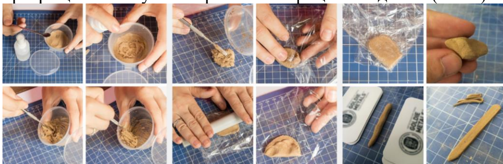
Рис. 2 Металлическая глина, способ ее производства
