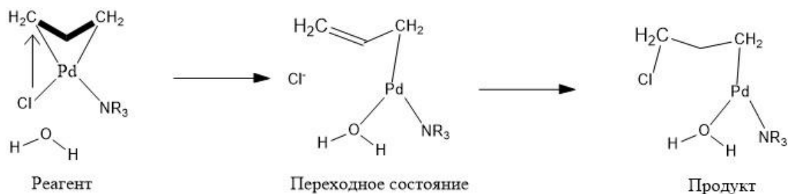
Рис.2. Механизм реакции нуклеофильной атаки ионом хлора в присутствии дискретной молекулы воды в качестве растворителя
