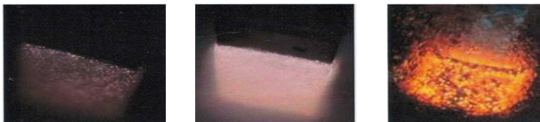
Этапы микродугового оксидирования: 1 - искровые разряды, 2 - микродуговые разряды, 3 - дуговое оксидирование
