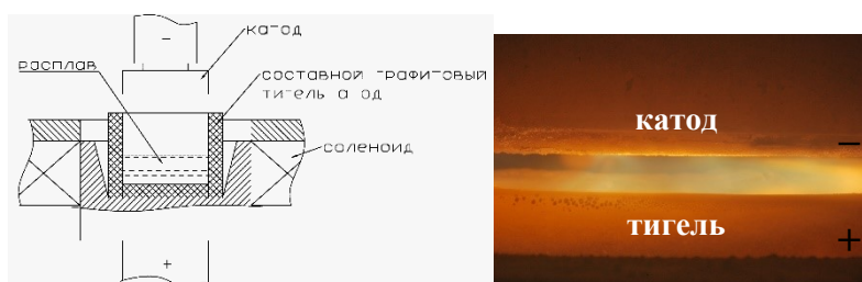
Рис.1 Схема экспериментальной установки и фотография дуги ( I=840\text{A} , U=34\text{В} , экспозиция 1/4000 )
