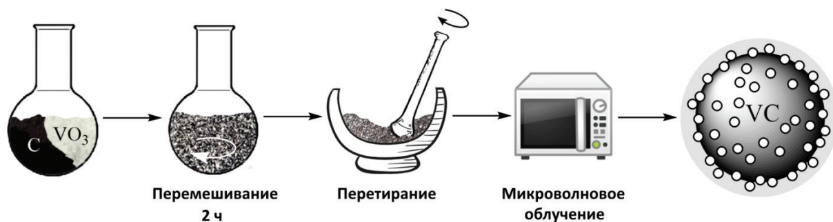
Рис. 1. Схема синтеза карбида ванадия
