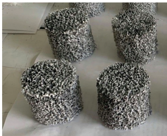
Рис. 1. ВПЯМ с нанесенным активным слоем АУ
